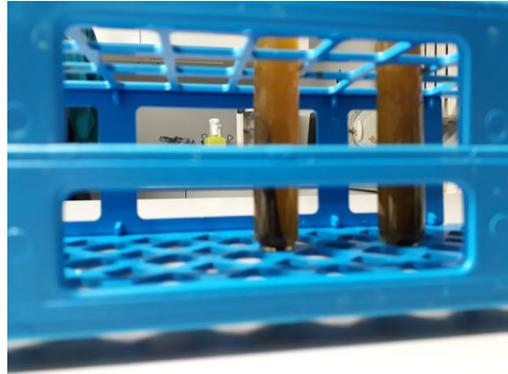
Abb.: Flotationsansatz nach dem Zentrifugieren
