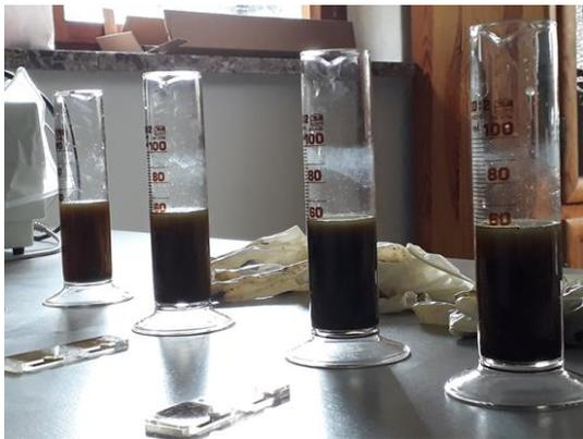
Abb.: Kotsuspension für das McMaster-Verfahren
